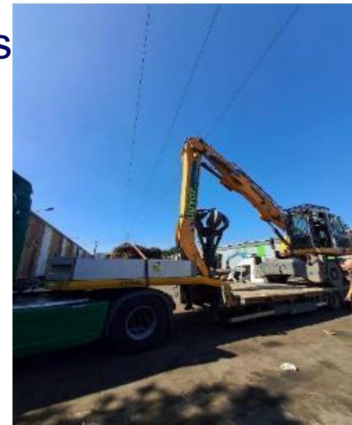
chargement d'une grue sur un porte- char, la grue a touché le réseau HTA aérien
